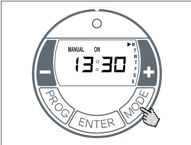
Durch Betätigen der Taste MODE wechselt die Betriebsart zwischen MANUAL ON, MANUAL OFF und AUTO.
