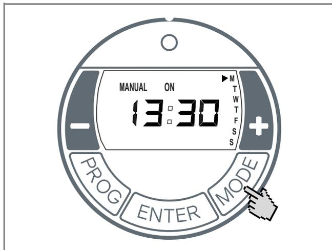
L'actionnement de la touche MODE permet de basculer entre les modes de fonctionnement MANUAL ON, MANUAL OFF et AUTO.
