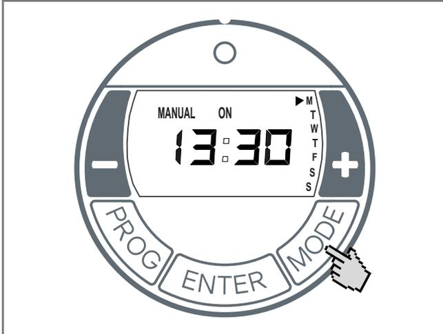
Premendo il tasto MODE, si passa alla modalità d'esercizio MANUAL ON, MANUAL OFF oppure AUTO.
